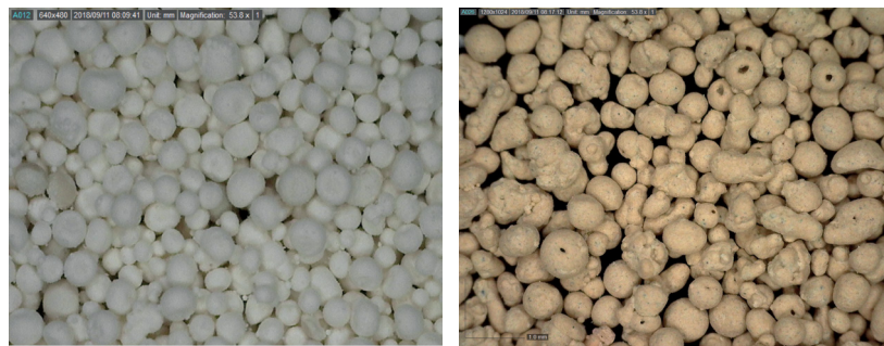
Figura 5.7 – Grânulos de composição de alumina e de piso cerâmico obtidos pelo processo de spray drying observados em lupa
