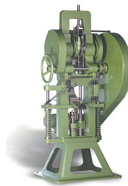
Figura 5.16 – Prensa a) mecânica, usada para prensagem de pastilhas cerâmicas, em que a movimentação do punção superior é realizada pela excentricidade do eixo ou prensa 18 ; b) hidráulica, usada para prensagem de pisos cerâmicos, em que a movimentação do punção é realizada por pistões 19
