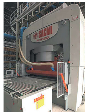
Figura 5.16 – Prensa a) mecânica, usada para prensagem de pastilhas cerâmicas, em que a movimentação do punção superior é realizada pela excentricidade do eixo ou prensa 18 ; b) hidráulica, usada para prensagem de pisos cerâmicos, em que a movimentação do punção é realizada por pistões 19
