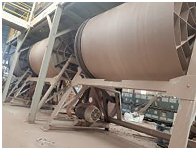
Figura 5.2 – Moinho de bolas industrial, 5 mil litros. Indústria de revestimentos cerâmicos 1
