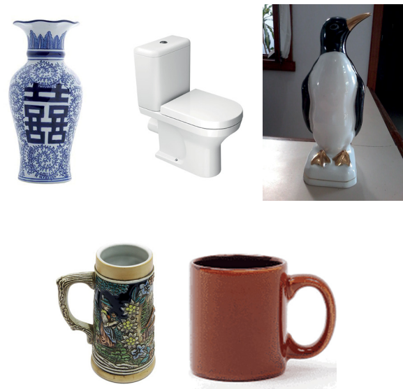
Figura 5.24 – Produtos cerâmicos obtidos por colagem de barbotina 25
