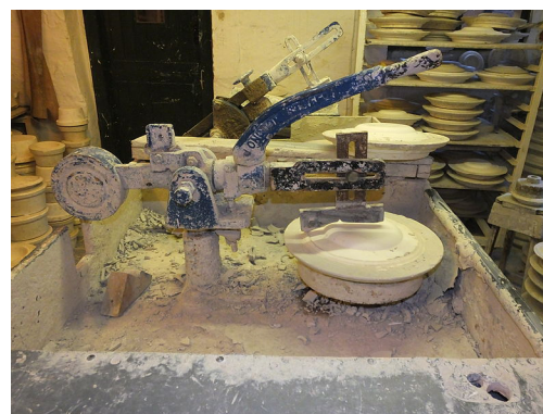
Figura 1.4 – Jigger para torneamento de prato 10
