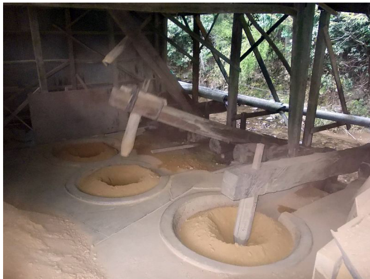
Figura 1.2 – Moinho a energia hidráulica, em uso no Japão 8
