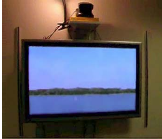
Fig. 6: Protótipo do sistema de janelas artificiais com câmera acoplada para efeito de paralaxe de movimento Fonte: Radicovick , 2004
