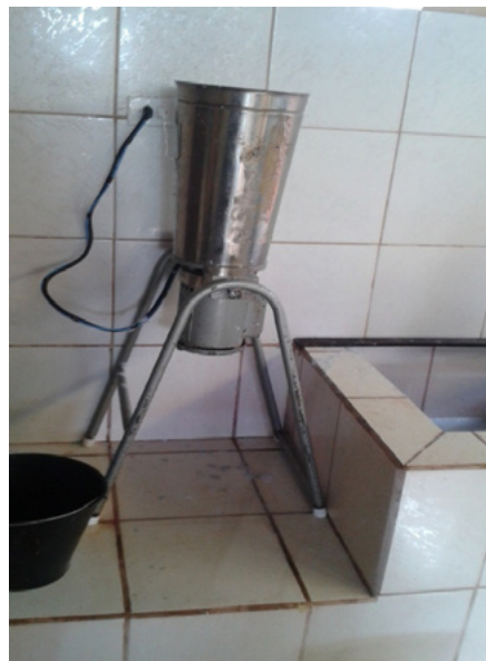
Figura 4 - Liquidificador industrial para triturar o papel picado
